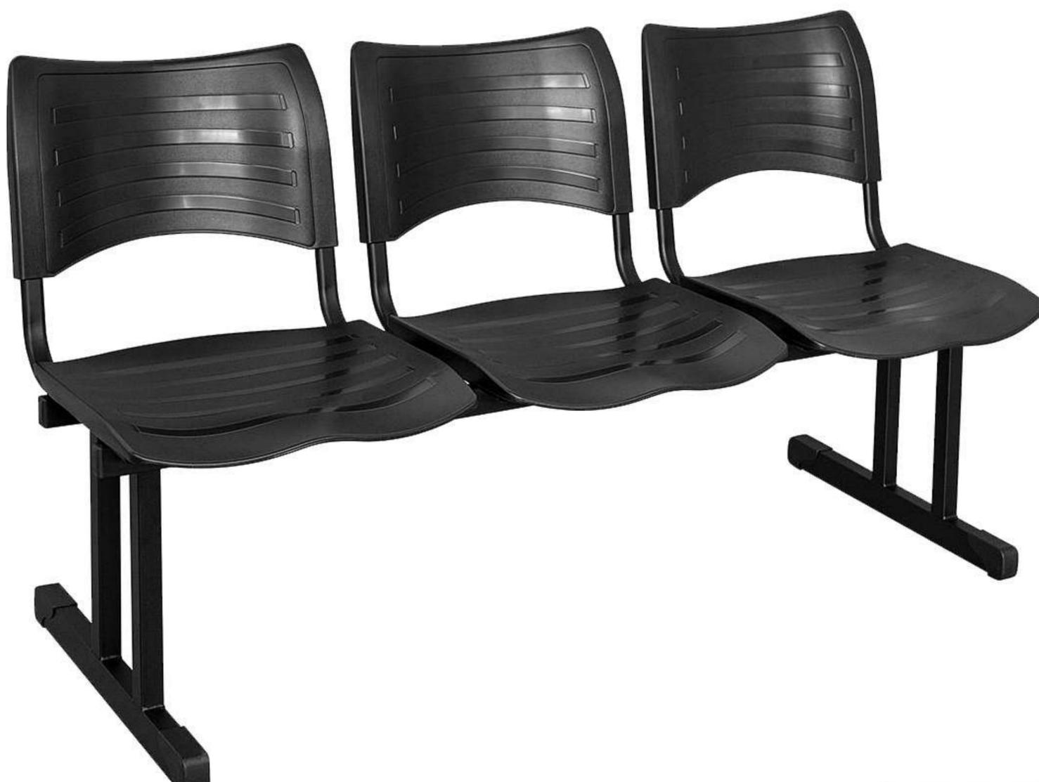
A longarina modelo ISO 3 lugares é uma opção de qualidade e durabilidade para espaços coletivos. Sua base é fabricada em tubo de aço retangular 40/20 chapa 20 e pés em tubo retangular 50/30 chapa 20, garantindo robustez e estabilidade ao produto. Além disso, sua estrutura metálica é sem dobras e soldada em solda MIG, o que confere maior resistência e segurança aos usuários.
